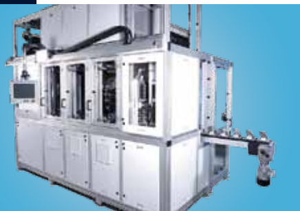
Abb. 1: Prüfanlage für Einspritzpumpen
