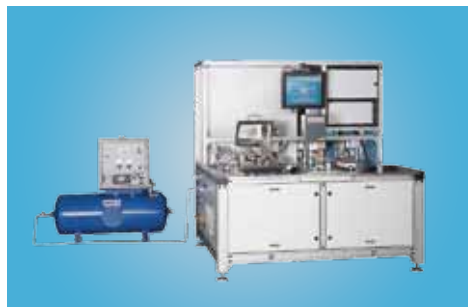
Abb. 2: Prüfanlage für CNG-/LPG-Komponenten
